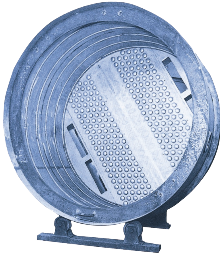
Lochplatte für zweiflutigen Glockenboden
